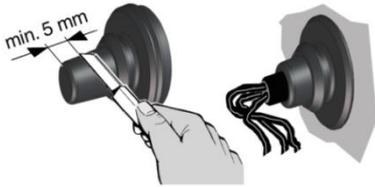
5. Leitungstülle [9] in Gehäuse einsetzen.
