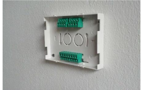
**Schritt 4:** Nehmen Sie das obere Geräteteil und setzen Sie es an der Halterung der an der Wand montierten Grundplatte an. Schließen sie das Gerät durch Aufsetzen des Geräteoberteils. Das Gerät ist fertig montiert, wenn es in der Halterung einrastet.
